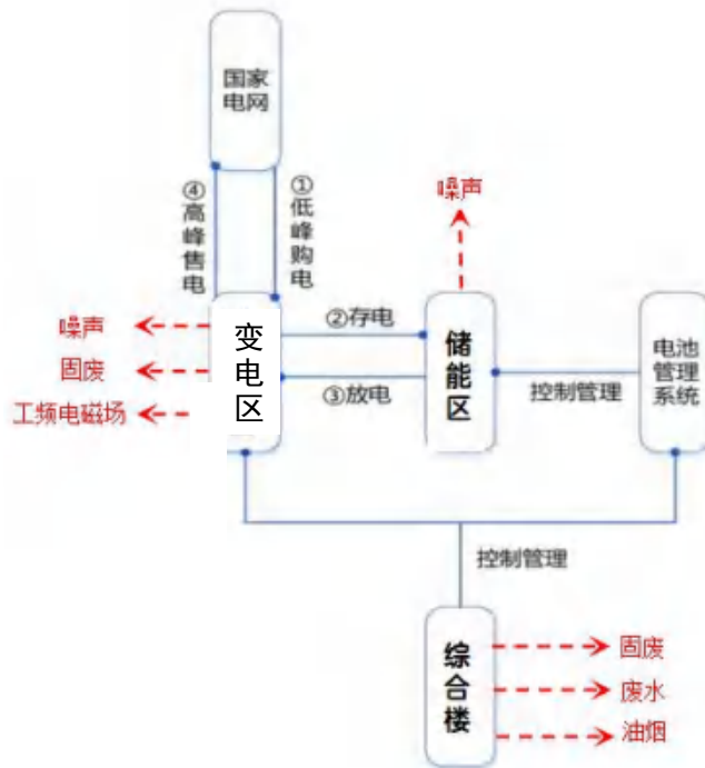
图 4-1 储能电站工艺流程及产污环节示意图
