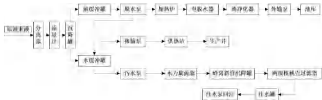
图 2-2 含油污水处理工艺流程示意图
