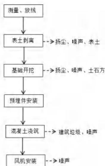
图 2-1 风机基础施工流程及产污节点图
