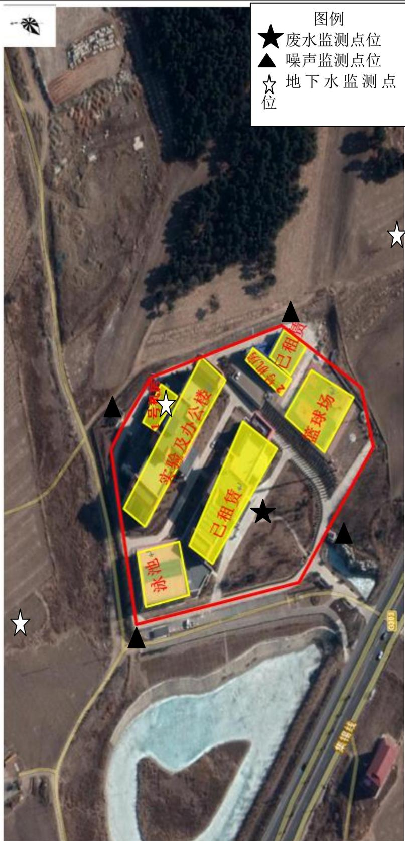
图 3-2 平面布置图及监测点位示意图
